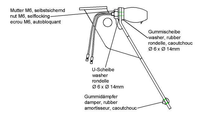
Den LSL-Kennzeichenhalter mit beiliegenden M6x10 (10Nm) vormontieren, dann anstelle des originalen Halters mit beiliegenden M8x45 (20Nm) und Distanzbuchsen (I=29mm) befestigen.
